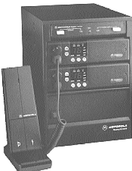
در شکل مقابل یک تکرار کننده را مشاهده می کنید که قسمت بالا گیرنده و قسمت پایین فرستنده می باشد و یک میکروفون جهت تماس اضطراری و تست آن بر روی دستگاه نصب شده است.
