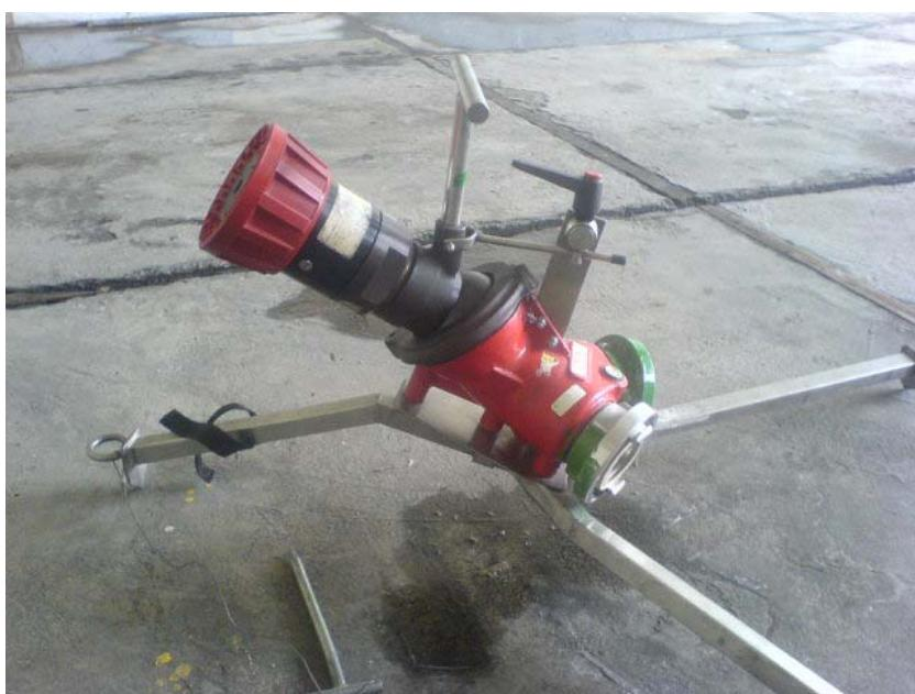
مانیتور فوق دارای پایه های تاشو است که این امکان را می دهد تا به آسانی در خودرو آتش نشانی قرار گیرد. پایه های این مانیتور از جنس فولاد سخت با سرهای کلنگی جهت نگه داشتن ثابت آن در مکان های ناهموار می باشد. وزن کامل آن تقریبا ۲۳ کیلو گرم می باشد.
