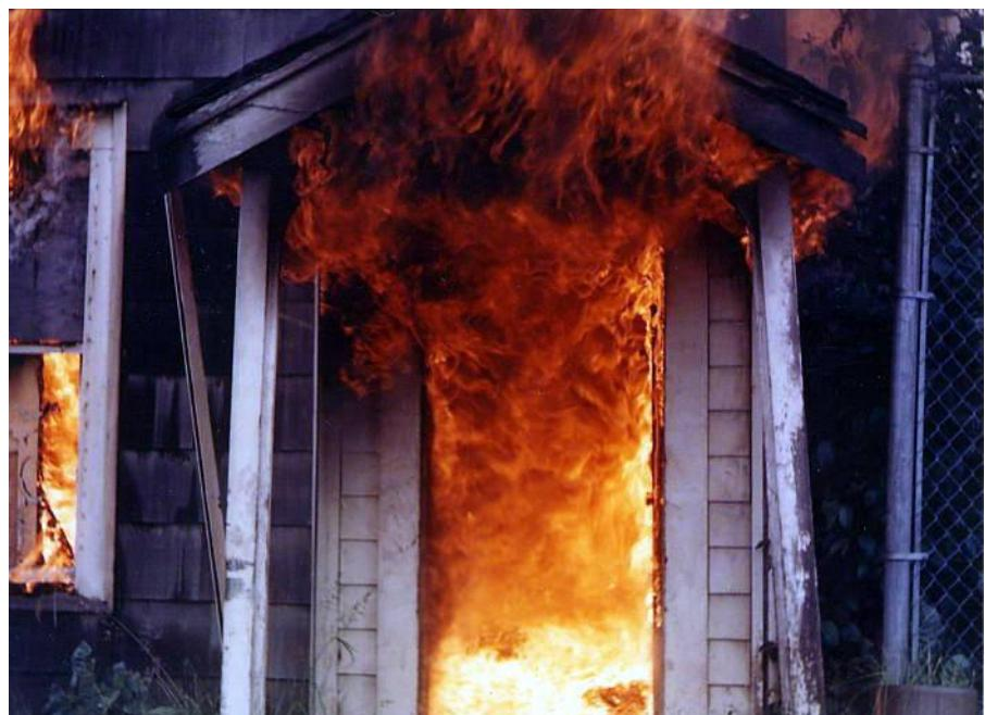
فلش اور ! این پدیده، خطرناک ترین لحظه حریق است . زمانی که اتاق سریعا و باحالت انفجاری شعله ور می شود ، فلش اور اتفاق افتاده است . از نقطه نظر علمی ، این پدیده به علت بازخورد تابشی حرارت اتفاق می افتد . گرمای برخاسته از حریق توسط دیوار فوکانی ( سقف ) و محتويات اتاق، جذب شده و دمای گازهای
